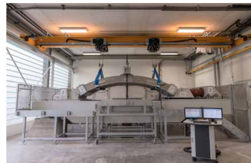
Der neue Tübbingprüfstand (Foto: Montanuniversität)
